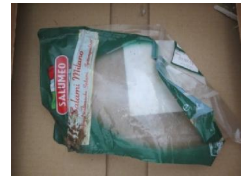
Beispielmaterialien, die nach Analyse mit dem tragbaren NIR-Spektrometer als Stärkeblend eingeordnet wurden
