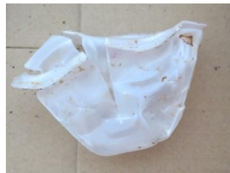
Beispielmaterialien, die nach Analyse mit dem tragbaren NIR-Spektrometer als Stärkeblend eingeordnet wurden
